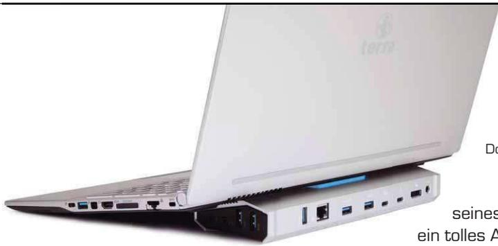
Die optionale Dockingstation erweitert die Schnittstellen des Laptops enorm, selbst wenn dieses schon außergewöhnlich gut ausgestattet ist, außerdem kann die stabile Dockingstation als Stütze dienen
